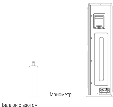
Рис. 3-10 Принципиальная схема процесса заполнения азотом и поддержания давления
