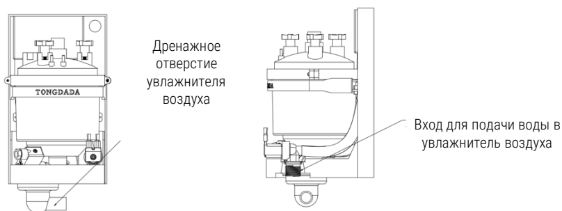
Рис. 3-9 Труба подачи увлажняющей воды
